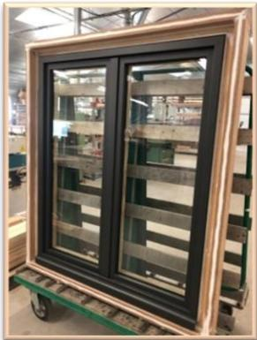
La menuiserie mixte authentique, en bois massif 68 mm avec capotage aluminium, en partenariat avec Joint Dual.
